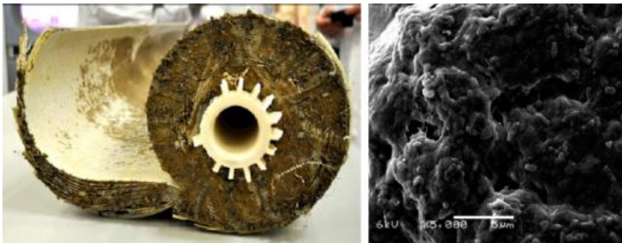
ภาพที่ 2-1 จุลินทรีย์สะสมที่ผิวหรือในรูกรองของเยื่อกรองจนเกิดไบโอฟิล์ม
