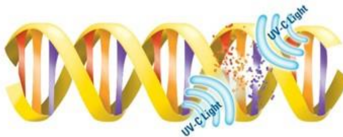
ภาพที่ 3-2 ภาพจำลองการทำลายจุลินทรีย์โดยรังสียูวี
