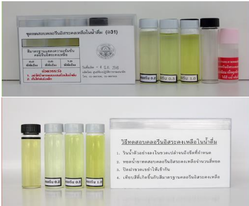
ภาพที่ 10-7 ชุดทดสอบคลอรีนอิสระคงเหลือในน้ำดื่ม (อ.31) พัฒนาโดยกรมอนามัย
